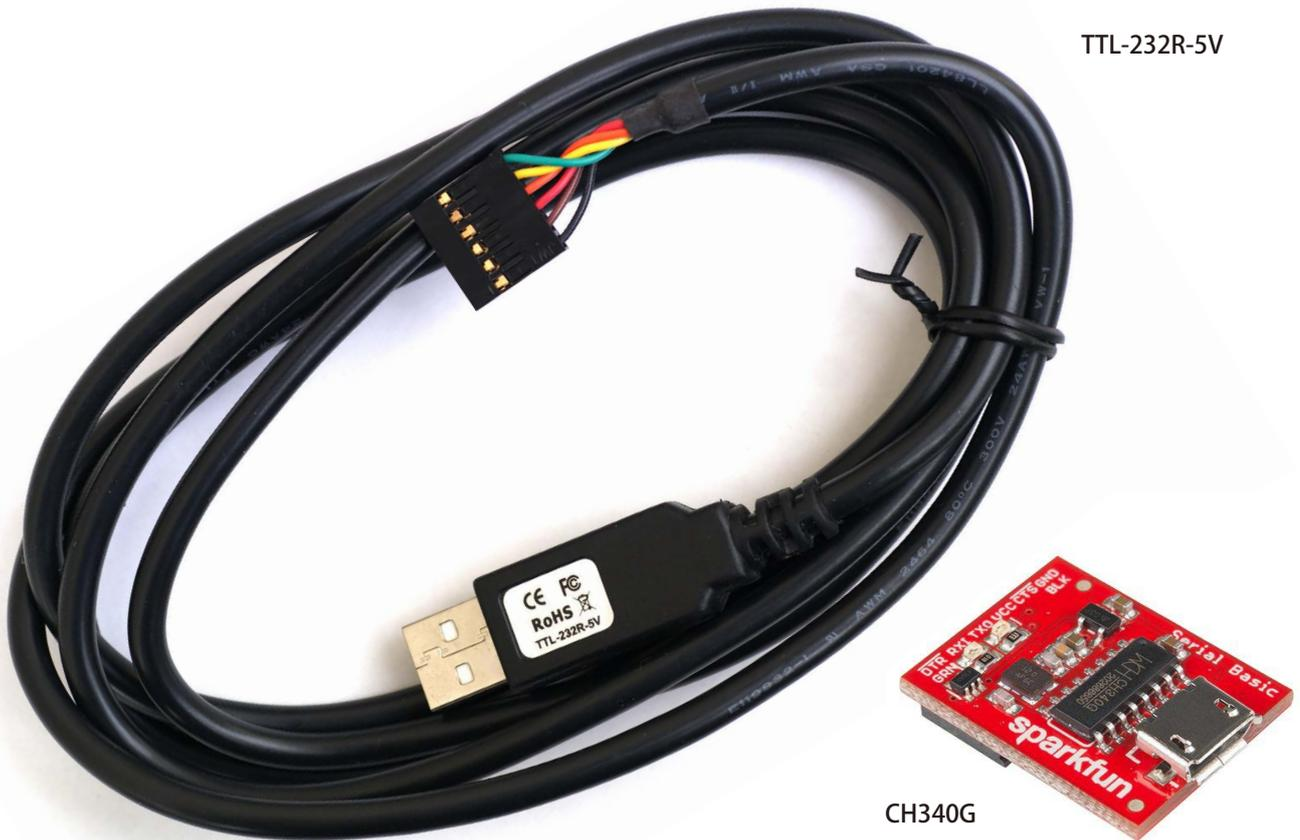
シリアル端子にはWRT8755側の信号名が印刷されています。これとUSB-シリアル変換ケーブルの信号がたすき掛けになるように接続します。すなわち、TXD⇄RXD、GND⇄GNDとなるのが正常です。なお、信号電圧3.3V/5V対応USB-シリアル変換アダプタを利用する場合は、信号電圧をあらかじめ5Vに設定しておいてください。
